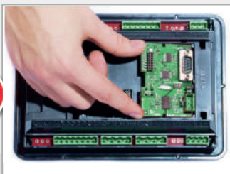
INTRODUZCA EL MÓDULO DE EXPANSIÓN EN UNA DE LAS DOS RANURAS
