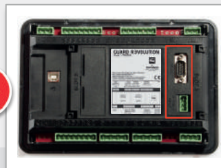
INTRODUZCA LA TAPA NUEVA (INCLUIDA EN EL KIT) CON LAS ABERTURAS PARA LAS EXTENSIONES
